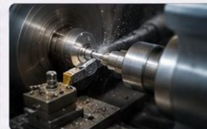
tření mezi nástrojem a obrobkem při obrábění
