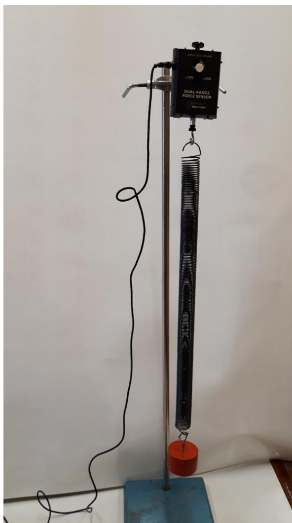
Obr. 4 Určení hmotnosti závaží pomocí siloměru.
