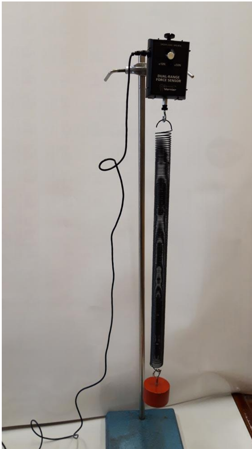
Obr. 3 Určení hmotnosti závaží pomocí siloměru.
